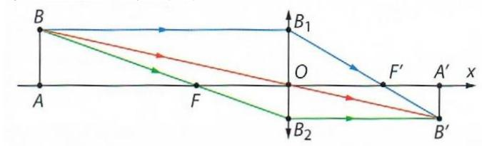
La distance focale f de la lentille est la distance entre centre optique-foyer : f = OF = OF'On considère le repere orthonormé d'origine O selon le schéma ci-dessus. On note f l'abscisse du foyer F' et le point A n'est pas placé en O  $(x_A \neq 0)$
